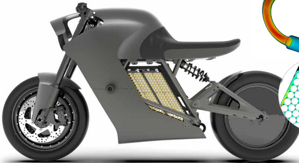
Bild 1: Das Motorrad ethec city wird 30 Prozent leichter und deutlich einfacher zu fertigen sein als der Vorgänger ethec alpha.
